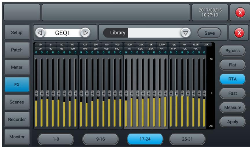
Cuando se completa la medición, el botón Measure se apagará. A continuación, cierre la página GEQ e inserte el GEQ en el bus I/D a través de la página de efectos o en la sección de entrada del bus I/D. Seguidamente, vuelva al GEQ, baje el atenuador principal y haga clic en Apply (aplicar), lo que cambiará sus faders para equalizar de acuerdo con la última medida.
