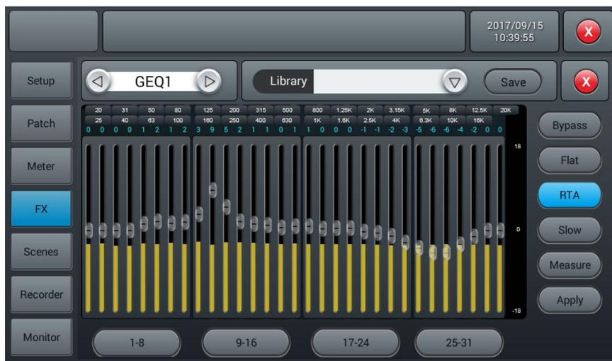
Tenga en cuenta que las frecuencias inferiores a 40Hz y superiores a 16kHz no se corrigen automáticamente, por lo que debe configurarlas manualmente.
