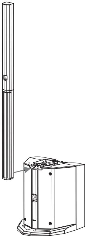
La colonne du MOJO500Line est directement montée sur le caisson grâce au slot de contact.
