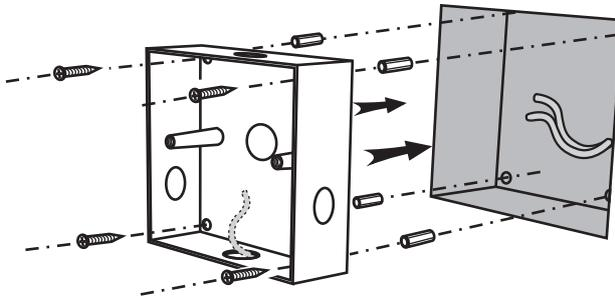
3 – Klipsen Sie die Frontabdeckung wie in nachstehender Abbildung gezeigt heraus und nehmen Sie vorsichtig die Rückseite des Steuergeräts ab.
