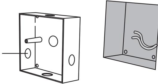
2 – Fixieren Sie das Unterputzgehäuse ordnungsgemäß mit für die Aufnahme geeigneten Dübeln.
