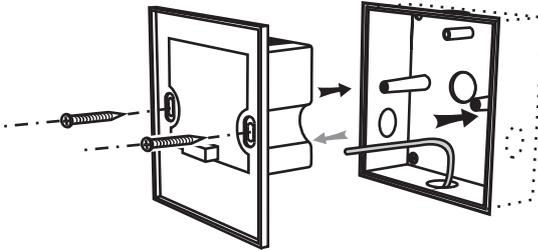
5 – Setzen Sie die Frontabdeckung vorsichtig auf und achten Sie darauf, dass Sie dabei den mehrpoligen Anschluss nicht beschädigen.
