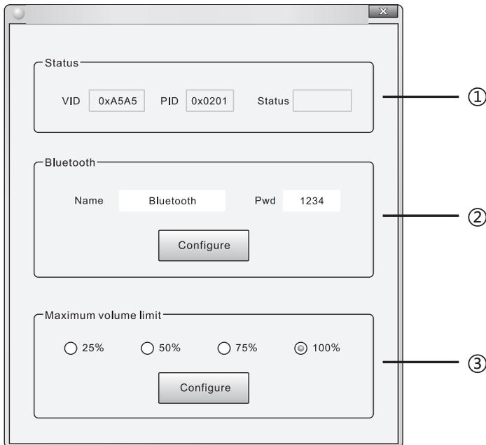
Schließen Sie am USB-Port einen Computer an. Installieren Sie dann auf diesem Computer die mitgelieferte Konfigurationssoftware und starten Sie sie anschließend.
