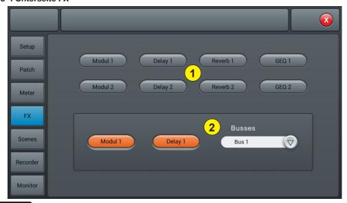
Die Effekte umfassen nachstehende 8 Module: 2 Modulatormodule, 2 Verzögerungsmodule, 2 Hallmodule und 2 grafische 15-Band-EQ-Module.
