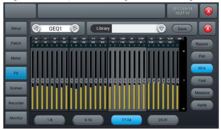
Wenn der Messvorgang abgeschlossen ist, wird die Schaltfläche Measure wieder ausgeblendet. Schließen Sie nun die Unterseite GEQ und schleifen Sie GEQ über das Eingangsmodul des linken/rechten Masterbusses auf der Unterseite FX im linken/rechten Masterbus ein. Gehen Sie anschließend zurück zur Unterseite GEQ, schieben Sie den Masterbusfader nach unten und tippen Sie anschließend auf die Schaltfläche Apply, wodurch die Fadereinstellungen entsprechend Ihrer letzten Einstellungen geändert werden.
