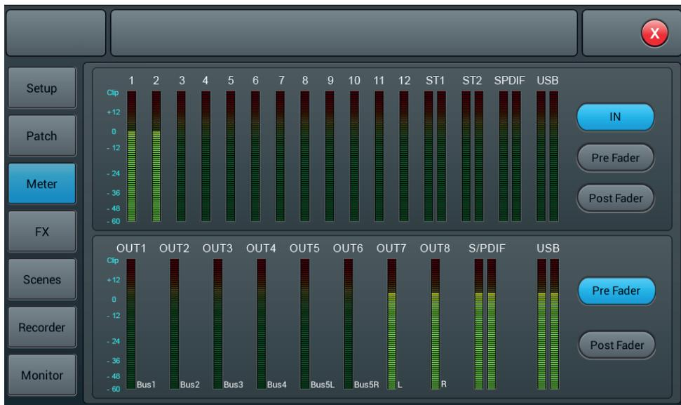
Le niveau de signal des canaux d'entrée a trois modes IN, Pre Fader et Post Fader avec Pre Fader par défaut. Pour sélectionner le mode de signal à afficher, cliquez sur le bouton correspondant.
