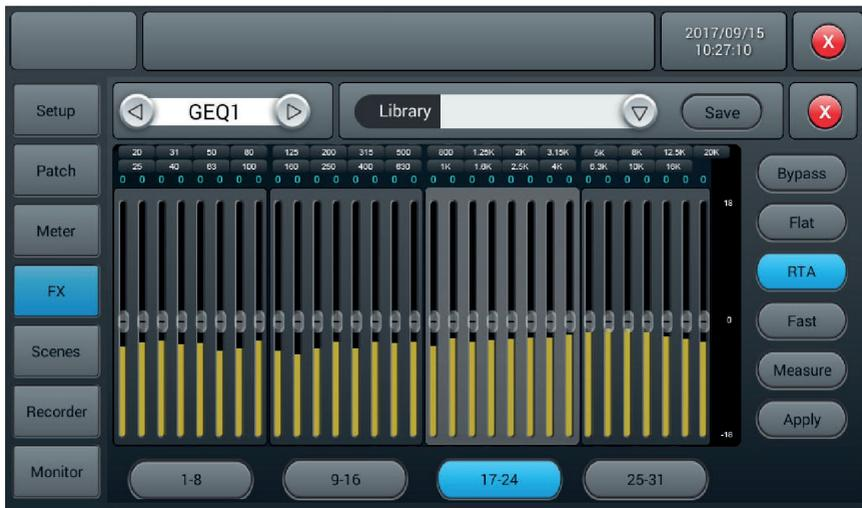
Lorsque la mesure est terminée, le bouton Measure s'éteint. Fermez maintenant la page GEQ et insérez le GEQ dans le bus L&R soit via la page d'effets, soit dans la section d'entrée du bus L&R. Puis retournez au GEQ, baissez le fader Master et cliquez sur Appliquer, ce qui changera vos faders pour égaliser en fonction de la dernière mesure.
