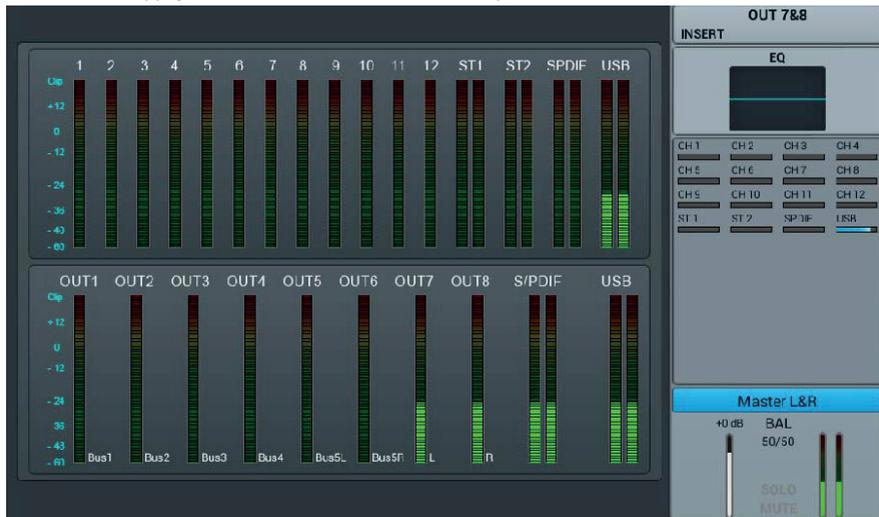
Le côté gauche de la page donne un aperçu complet de toutes les entrées et sorties de la console, le côté droit montre la bande de sortie Master L/R, dont la fonctionnalité suit exactement les bus stéréo 7-8.
